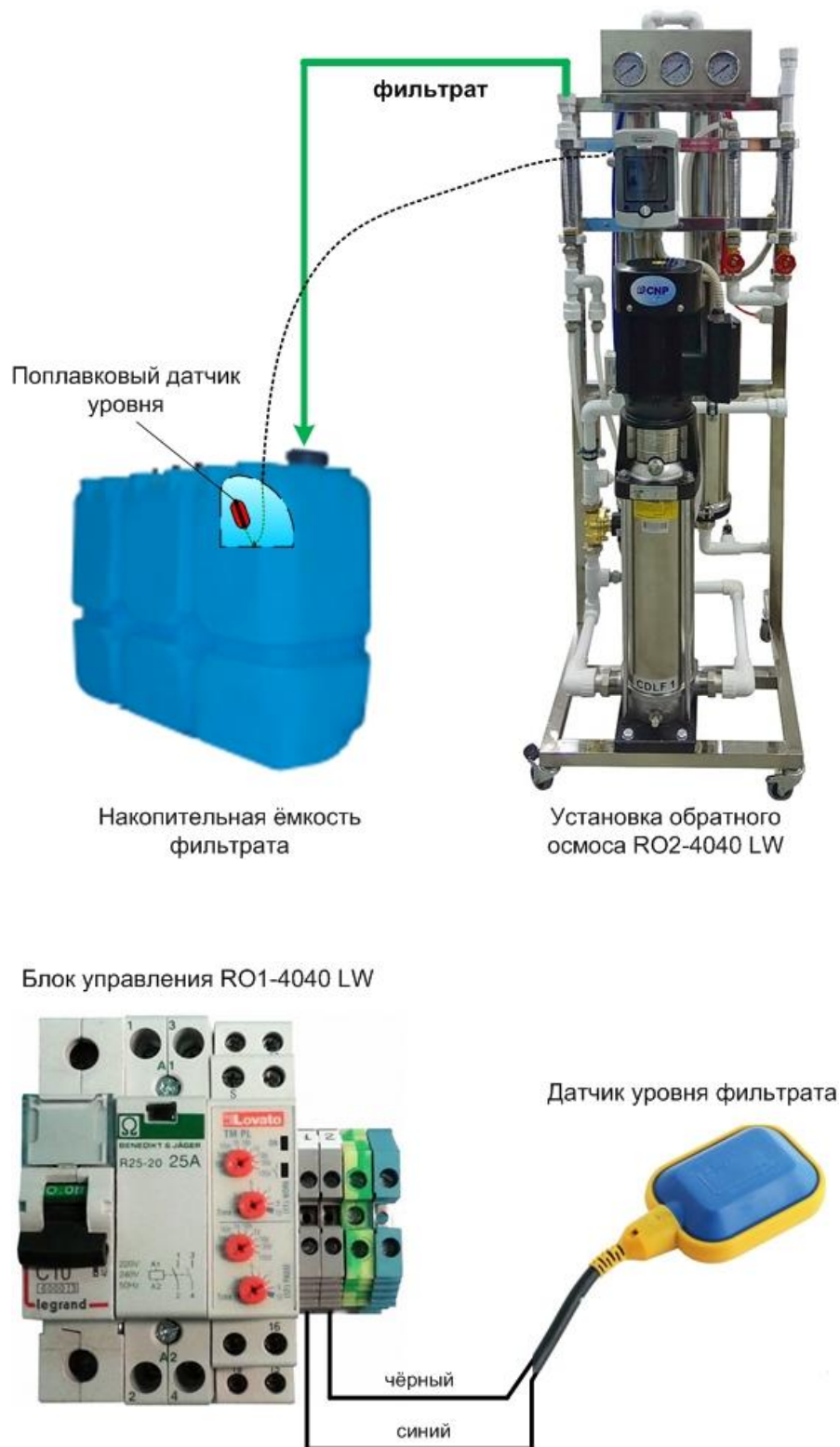
Рис. 4. Подключение датчика уровня к установке.
